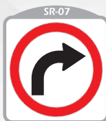
GIRO A LA DERECHA SOLAMENTE
